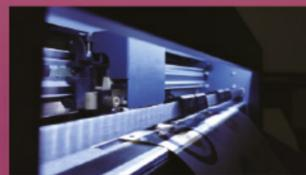
Благодаря использованию деталей из высококачественных материалов, в частности, алюминиевому кожуху, каретке обеспечивается оптимальная защита, более продолжительный срок службы и лучший теплоотвод от корпуса. В высокоэффективном рабочем режиме на подачу листа требуется всего 2 секунды и 3 секунды необходимы для сканирования меток. Всего 23,5 секунды потребуется на то, чтобы вырезать 24 круга диаметром 60 мм.
