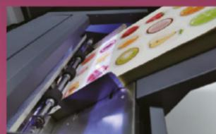
Уникальная система автоподачи носителя адаптирована под широкое разнообразие материалов и позволяет одновременно загрузить до 300 листов формата А4. Эта система подходит для работы с листами нескольких форматов - А4, А3 и А3+. Конструкция податчика с подвижными боковыми ограничителями не допускает смещения бумаги и гарантирует высокую точность перемещения листов. Время подачи - 2 секунды.
