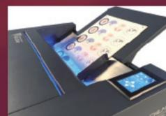
Светодиодная подсветка вдоль всей рабочей зоны обеспечивает хорошее равномерное освещение, чем предотвращается прерывание сканирования во время считывания меток. Кроме того, подсветка позволяет легко контролировать процесс резки и вовремя обнаруживать недостатки обработки в случае их случайного возникновения.
