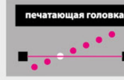
Поток чернил определяется как дефектный в случае фиксации светового луча специальным датчиком.
