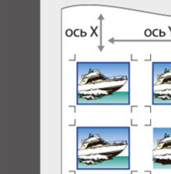
Путем непрерывного распознавания 4 меток вложенные изображения могут быть вырезаны в направлении X и Y осей с автоматическим выравниванием каждого графического элемента. При использовании программного средства Mimaki Fine Cut достаточно обнаружить лишь одну реперную метку.
