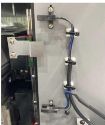
Z. Zero: нулевое положение каретки; Z.NL: нижнее предельное положение каретки;
